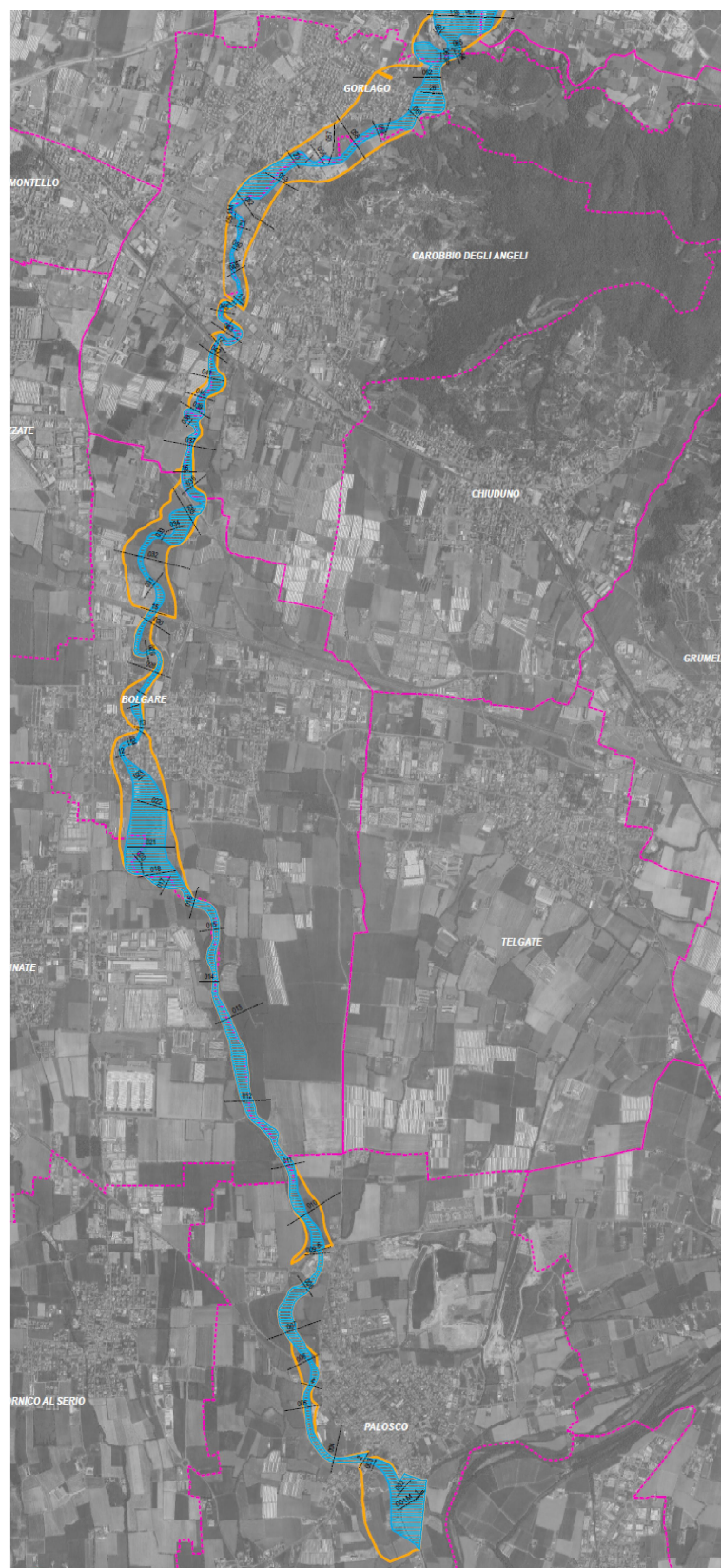
Figura 52 – Confronto fra l'area di esondazione centennale nello stato di fatto (linea arancione) e in progetto (in azzurro)
